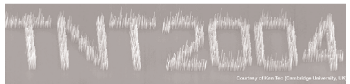
Figura 4. Nanotubos de carbono ordenados sobre una superficie mediante técnicas de litografía electrónica. TNT 2004 es el logo del congreso internacional Trends en nanotecnología (tomada de referencia 19).
